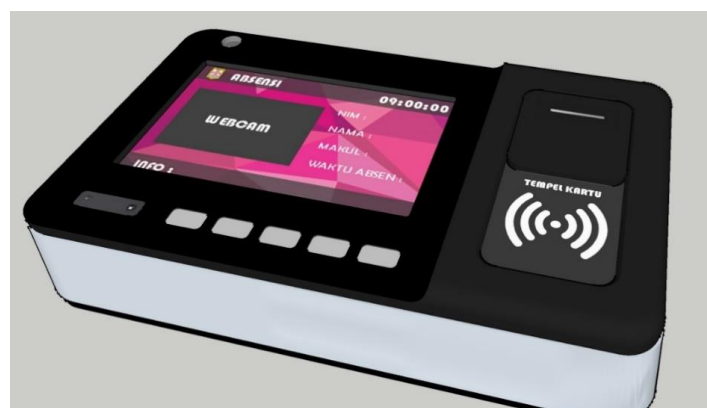
Gambar 8. Rancangan Perangkat Absensi dengan RFID (Tampak Bawah)
