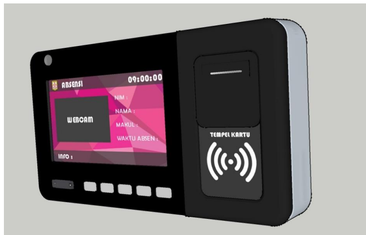
Gambar 9. Rancangan Perangkat Absensi dengan RFID (Tampak Samping)
