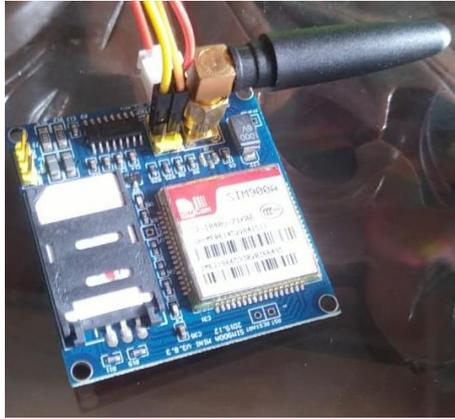
**Gambar 8.** Perangkat Modul GSM 900 A
