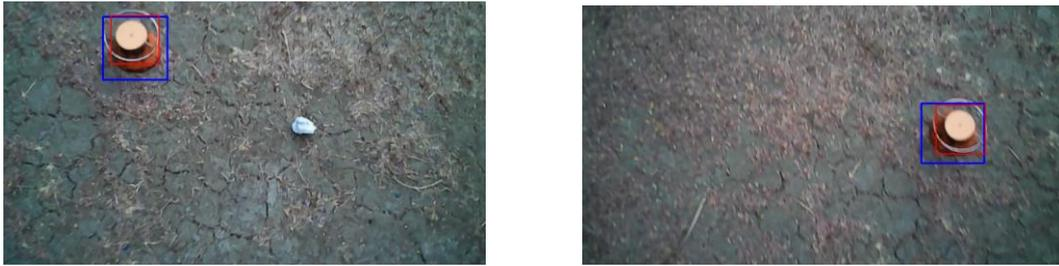
**Gambar 13.** Deteksi objek dengan kontur warna dan *Haar Cascade*
