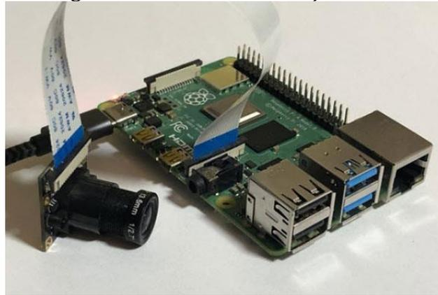
**Gambar 2.** Raspberry PI dan kamera untuk memproses gambar
